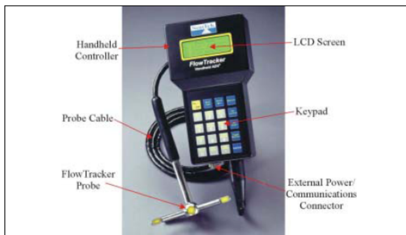
Figure 30 : Appareil Flow Tracker avec sonde 2D
